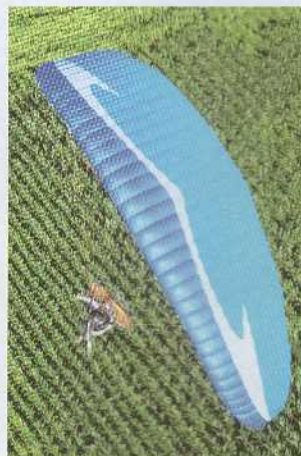
L'enduction siliconée du tissu utilisé par Apco donne à la Lift un bel aspect luisant.
