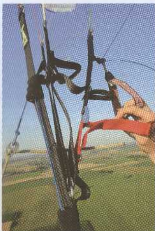
Les élévateurs de la Lift ont une belle finition. À noter que dans cette position de trim (sangle rouge à 1/3), l'aile est déjà dans sa configuration entièrement détrimée !
