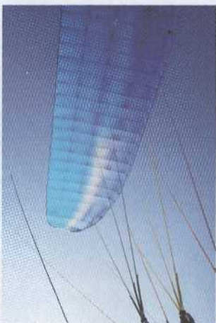
Pour diminuer la traînée, Apco a conçu un élévateur à 3 branches ! La rangée des D existe bel et bien. Elle est matérialisée par la bande de renfort près du bord de fuite.
