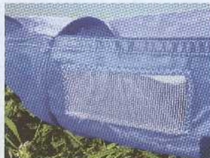
Une HIT Valve est composée d'un filet rectangulaire à l'extérieur et d'une pièce de tissu à l'intérieur. Lorsque le pilote détrimme ou accélère, l'angle d'incidence de l'aile diminue ce qui a pour effet d'ouvrir ces valves. Ainsi, l'air pénètre de l'extérieur vers l'intérieur du profil et sa pression interne s'en trouve augmentée.
