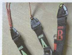
Les A et les B sont chacun repérés par des grosses lettres colorées : impossible de se tromper !
