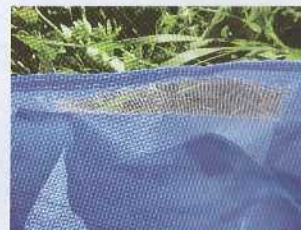
Une HIT Valve est composée d'un filet rectangulaire à l'extérieur et d'une pièce de tissu à l'intérieur. Lorsque le pilote détrimme ou accélère, l'angle d'incidence de l'aile diminue ce qui a pour effet d'ouvrir ces valves. Ainsi, l'air pénètre de l'extérieur vers l'intérieur du profil et sa pression interne s'en trouve augmentée.
